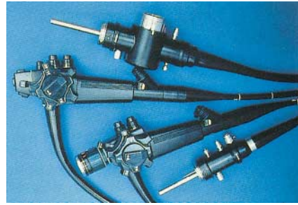
Abb. 1.3 Videoendoskop oben, Fiberendoskop unten
