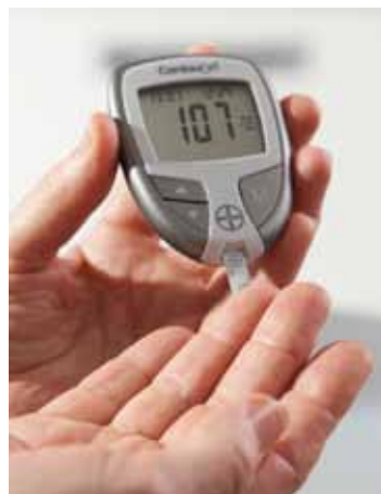
Abb. 1 Das Blutzuckermesssystem von Bayer (Contour® XT) liegt mit seinen Messwerten zu 100% im Toleranzbereich der neuen ISO-Norm 15197:2013.
